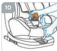
Sujete la base del asiento con una mano, luego sostenga el anillo del mango del apoyacabeza, tire del apoyacabeza a la altura adecuada (fig.11).
