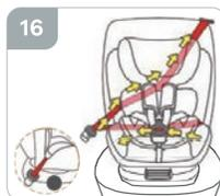
Luego de instalar el ISOFIX, retire el cinturón del automóvil y pase el cinturón diagonal por la guía celeste del respaldo y luego por debajo del apoyacabeza. Y el cinturón de regazo pase por debajo del cojín interno y finalmente abróchelo (fig.15).
