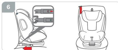
Coloque al niño en la butaca e instale el cinturón del automóvil, pase el cinturón pectoral por la ranura guía del cabezal y el cinturón del regazo por la ranura de guía del cinturón en la base, abróchelo. Luego tire y ajuste la correa (fig.7).
