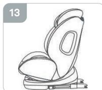
Apunte 2 conectores FIX a los anclajes ISOFIX en el asiento del vehículo, presiónelos para que se conecte, hasta que escuche CLIC (fig.13).
