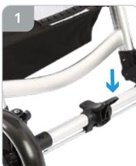
**Paso 1:** Para desactivar el freno, presione la palanca de freno como se muestra en la imagen para liberarlo (fig.2).
