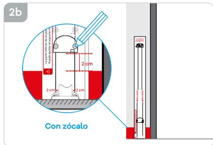
**Paso 3:** Perfore los agujeros e instale los soportes de las puertas. El gancho debe estar completamente bloqueado en la puerta (fig.3).
