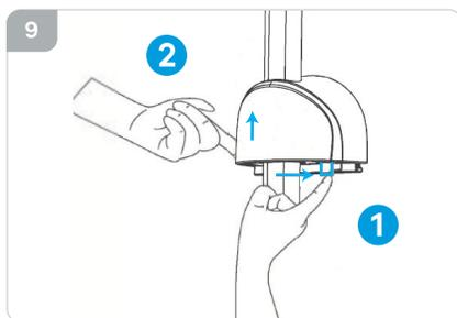
**Paso 1:** Deslice la perilla indicada (1) y mueva la puerta hacia arriba simultáneamente (fig.10).
