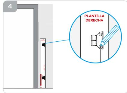
**b. Con zócalo:** fije el mango inferior lo más cerca posible del zócalo, deslícelo hasta la plantilla y marque la posición de los orificios de montaje (fig.5b).
