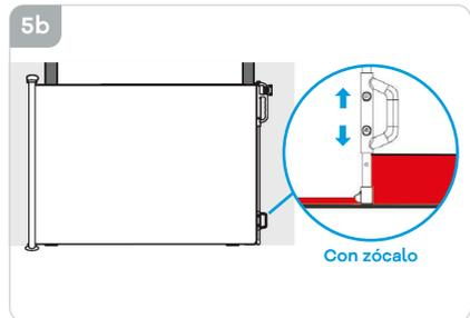
Si hay un zócalo, use el espaciador con el soporte de la puerta y el soporte de retención superior para compensar el ancho del zócalo.
