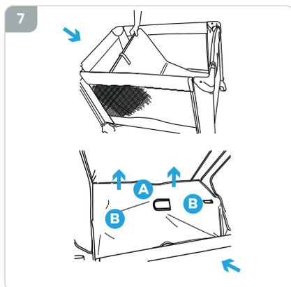
Presione las trabas internas de cada lateral (**fig. 8**) y empuje hacia abajo para plegar la cuna nuevamente. Repita esto con los cuatro lados hasta tener la cuna completamente plegada.
