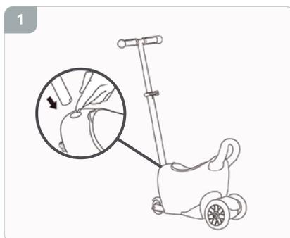
Para ajustar la altura del manillar, libere el anillo de ajuste central y, presionando la traba, mueva el caño a la altura necesaria. Luego vuelva a cerrar el anillo de ajuste **(fig.2).**
