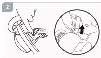
Por último, inserte el caño del manillar en el orificio, con el perno mirando hacia las dos ruedas. Asegúrese de escuchar el "CLICK" que indica el encastre (**fig.3**).
